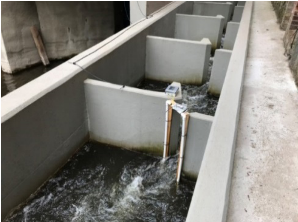
Fot. 1. Antena pętlowa RFID w szczelinie przepławki (Fot. Piotr Dębowski, IRŚ)
