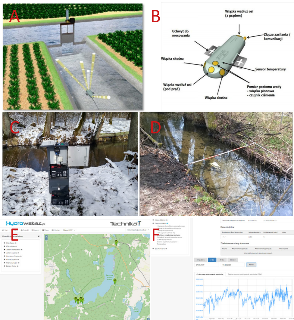
Rys. 2. System pomiarowy wykorzystywany w badaniach: schemat pracy przepływomierza (A), budowa miernika (B), stacja nadawcza na stanowisku pomiarowym podczas prac serwisowych (C), przepływomierz w warunkach operacyjnych, stanowisko na dopływie w m. Łąjs (D), oprogramowanie wizualizacji danych (E, F). Grafiki A i B – materiały dystrybutora ( www.envag.com.pl ), fotografie: M. Łopata
