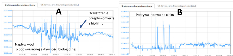
Rys. 3. Wpływ obrastania błoną biologiczną sensorów modułu podwodnego przepływomierza (A) i zjawisk lodowych (B) na odczyty przepływu chwilowego
