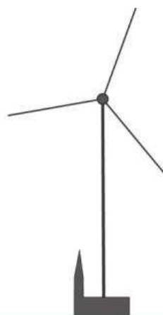
Rys. 10: Należy unikać umieszczania turbin wiatrowych bezpośrednio w linii z zabudowaniami wiejskimi czy budowlą wolnostojącą
