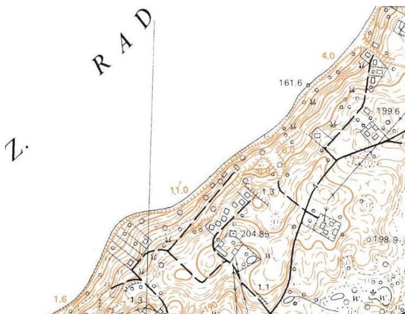
Ryc. 11. Fragment mapy topograficznej 1:10000 „starszej” z terenu Kaszubskiego PK może być pomocny przy ocenie ryzyka złamania zakazu podczas realizacji zagospodarowania stref brzegowych jezior rynnowych. Różnicowanie wysokościowe obrazują zarówno rysunek poziomic, jak i oznaczenia skarp (np. brzeg jeziora stanowi skarpa od 1,6 do 11,0 m wysokości) oraz punkty wysokościowe. Źródło: Geoserwis GDOŚ (dostęp: 10.09.2023 r.).
