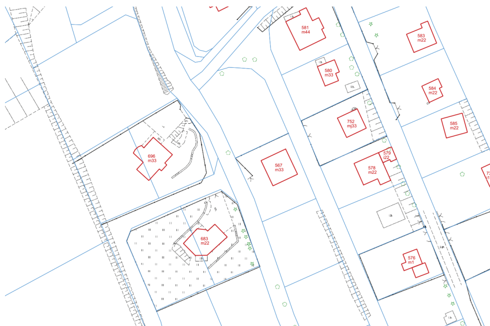
Ryc. 10. Fragment mapy wygenerowanej z portalu Geoportal dla terenu PK Góry Opawskie przedstawiający lokalizację budynków (na czerwono), granice działek ewidencyjnych (na niebiesko) oraz oznaczenia topograficzne wybranych elementów rzeźby terenu – skarp (na czarno) (dostęp: 10.09.2023 r.).
